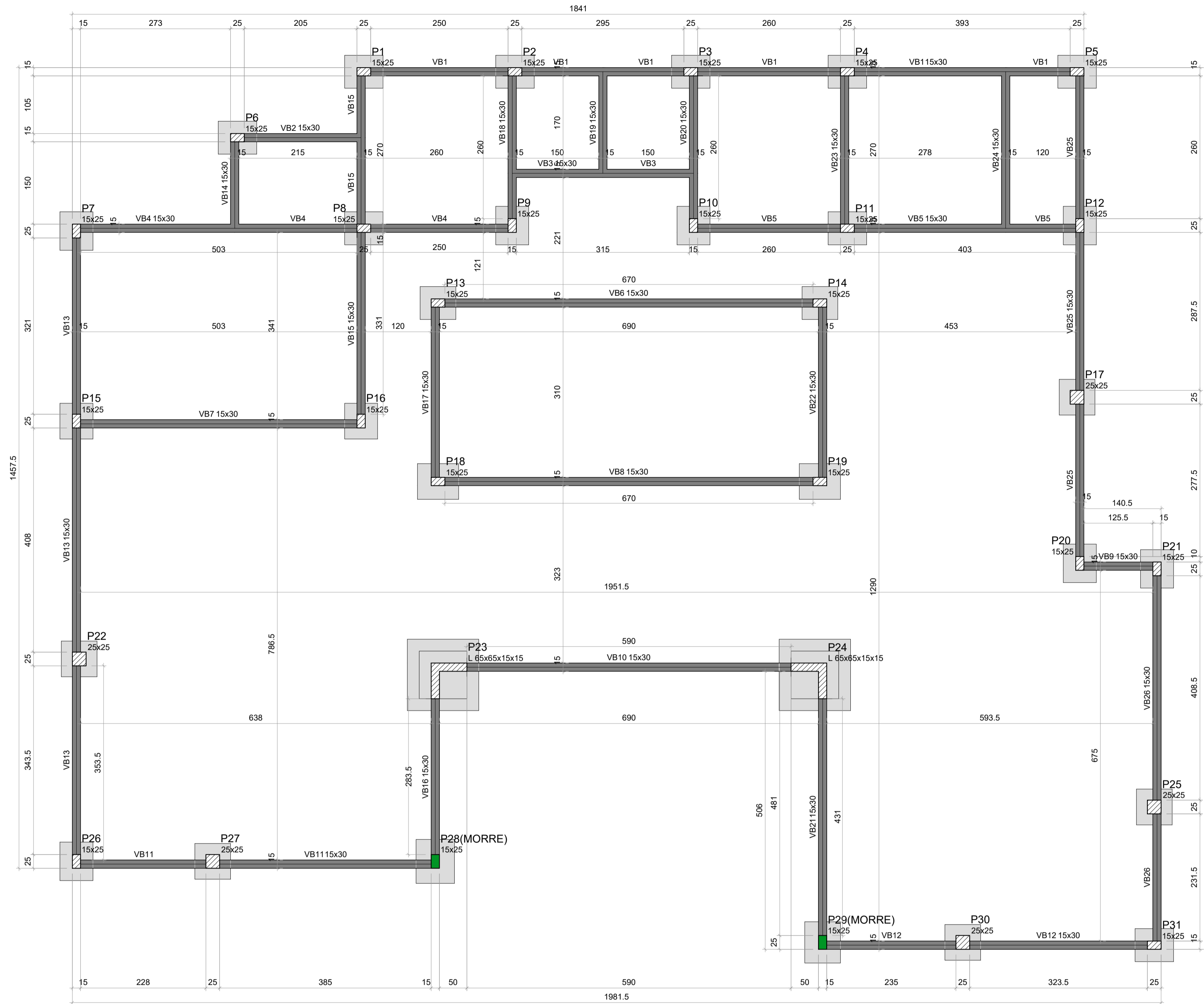
01 FORMA DO PAVIMENTO BALDRAME ESCALA: 1:50
